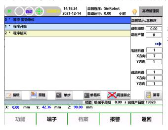
在此界面,可操作系统自动运行,停止,单步运行,单循环运行,调整自动运行速度等。
