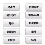
系统目前提供指令有: 1.轴动作指令、2.输出动作、3.等待、4 变量操作、5IF 指令、6 多轴定位、7 堆叠、8 机床对接、9 条件、10 标签
