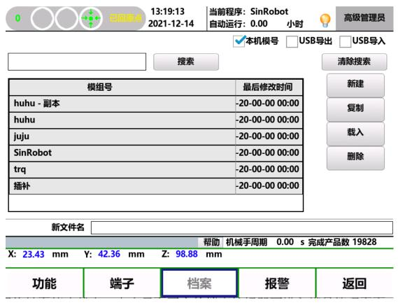
将操作器选择按钮旋转至停止状态,点击界面下方的档案按钮即可进入程序管理页面。
